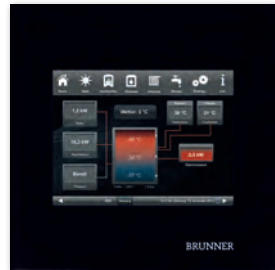
BHZ. Heizzentrale mit integrierter Systemsteuerung ... für das Wärme- und Energiemanagement eines Gebäudes.
