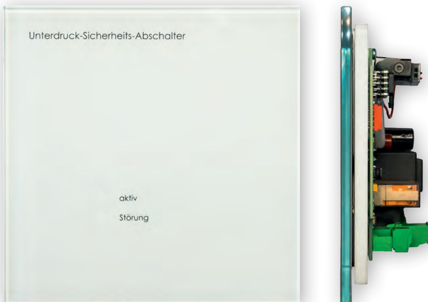
Unterdruck-Sicherheits-Abschalter USA 4 mit Glasfront. Hinter der abnehmbaren Glasplatte (12 x 12 cm) ist ein Zeilendisplay mit Bedienelementen verbaut. Der Fachbetrieb kann damit den aktuellen Differenzdruck und Daten zur Inbetriebnahme und Funktionskontrolle aufrufen. Der USA ist vom Gesetzgeber als Sicherheitseinrichtung bauaufsichtlich zugelassen (DIBt; Nummer: Z-85.1-8).
