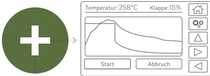
Durch Antippen des Flammensymbols wird das Untermenü mit den Verlaufskurven aufgerufen. Hier wird die aktuelle Phase der Abbrandregelung über ein zeitlich mitgeführtes Verlaufsdiagramm dargestellt.
