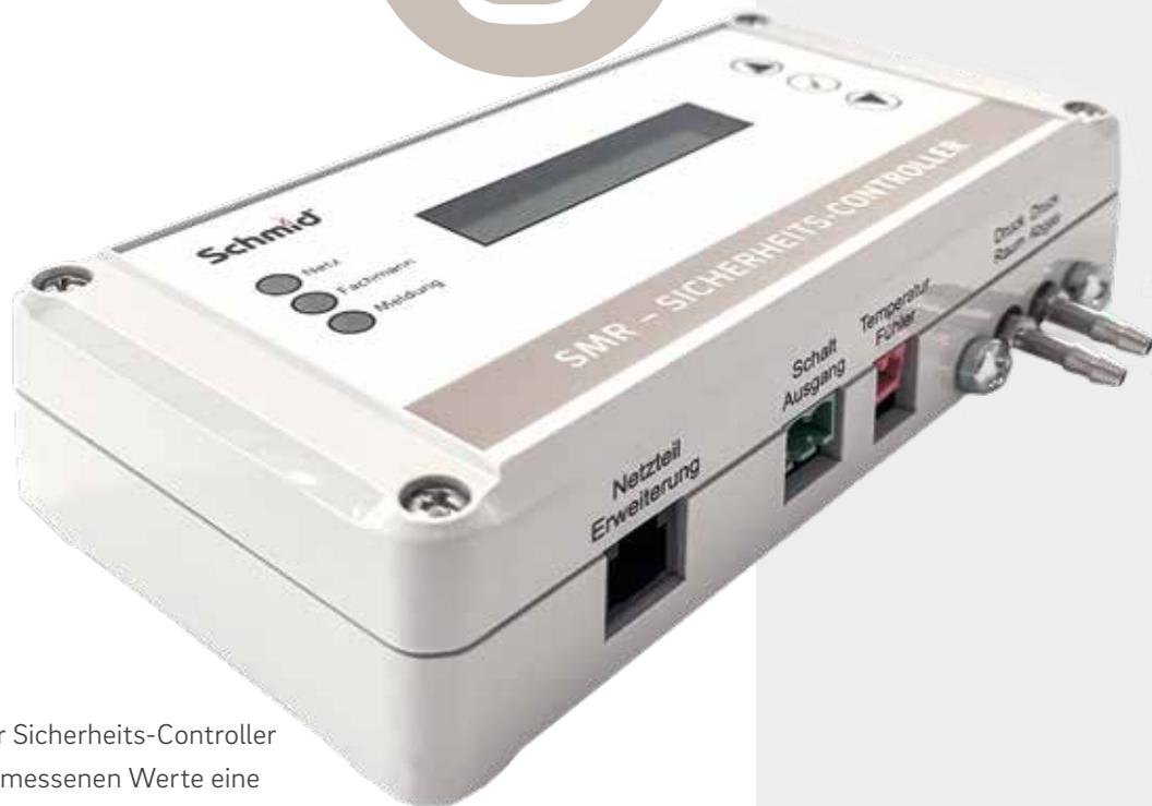
Ermittelt der Sicherheits-Controller durch die gemessenen Werte eine Druckunterschreitung, schaltet er automatisch die Lüftungsanlage aus.
