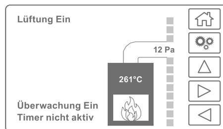
Betriebsanzeige für den SMR Sicherheits-Controller beim Parallelbetrieb von Lüftungsanlagen mit raumluft-abhängigen Feuerstätten.
