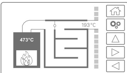
Anzeige der Abgastemperatur, wenn ihr Kamin über keramische Züge und einen zusätzlichen Abgasfühler verfügt.
