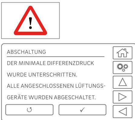
Sobald Störungen im Betrieb erkannt werden, wird blinkt diese Anzeige Rot auf. Durch Antippen des Symbols werden die Meldungen im Klartext angezeigt.
