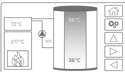
Die Grafik „Wasserspeicher“ ist aktiv, wenn Ihre Ofenanlage über eine SMR Kompakt-Station verfügt. Durch das Antippen des Symbols werden die aktuellen Werte im Untermenü angezeigt.
